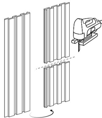
Les panneaux Linério peuvent être installés de façon horizontale, verticale ou bien en diagonale. La découpe s'effectue à l'aide d'une scie sauteuse, scie pendulaire ou scie sur table. Les lames sont à denture moyenne.
