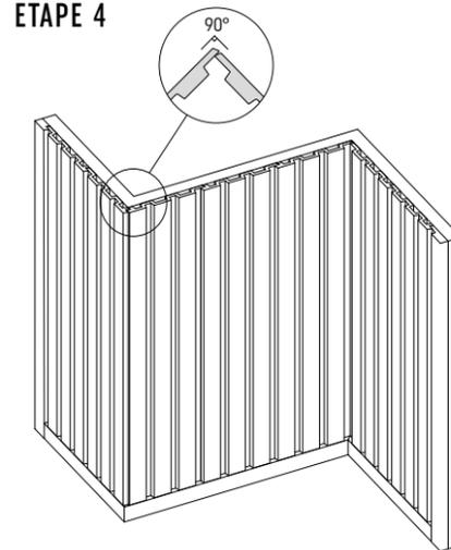
L'assemblage de l'angle sortant se fait par la superposition précise des panneaux l'un contre l'autre.
